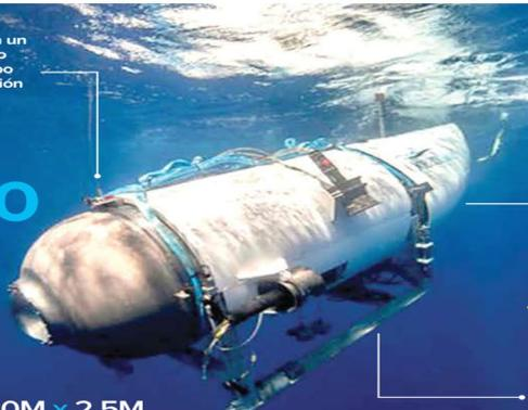
*Titan, el sumergible tripulado, cuenta con un sistema de monitoreo que detecta en tiempo real cambios de presión y fallas en la nave.*
