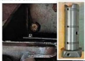
2. Tornillo alterado y degollado en placa de seguridad.
